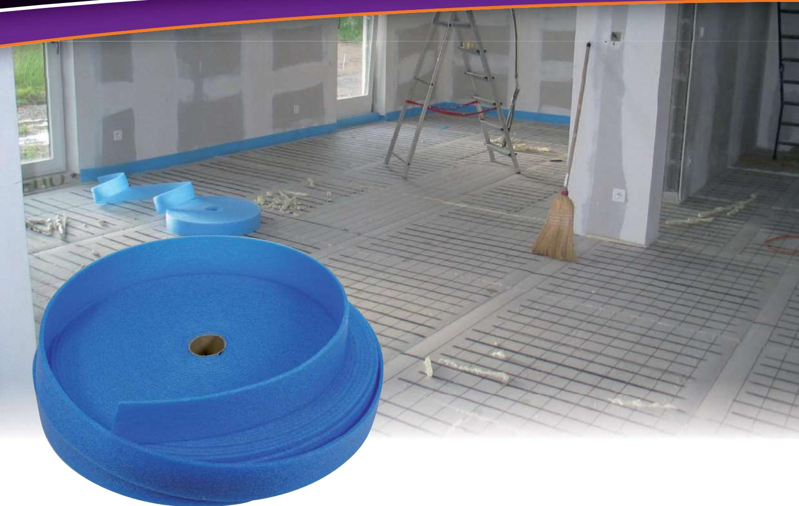
Chap'band agit comme un joint de dilatation entre chape et mur. Elle isole physiquement et acoustiquement la chape par rapport au mur et évite les fissures au niveau de la cloison.
